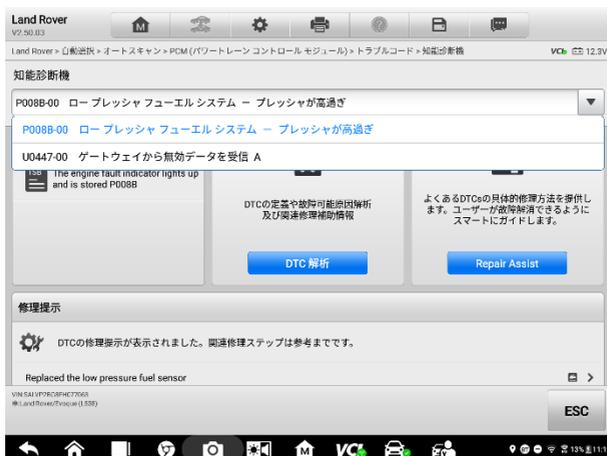
図 5-16 車両システムと検出された DTC 画面のサンプル
