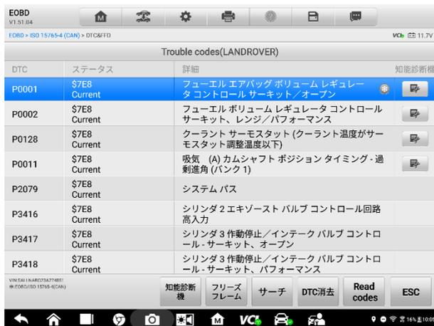
図 4-29 DTC と FFD 画面のサンプル
